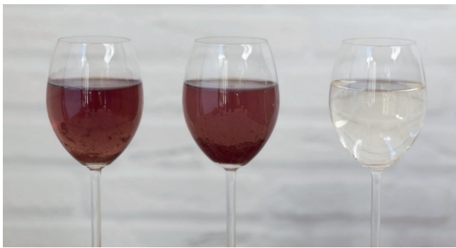
Rys. 1: Ciemno brązowy osad w roztworze doksycykliny o zbyt wysokim pH (po 24 h)
